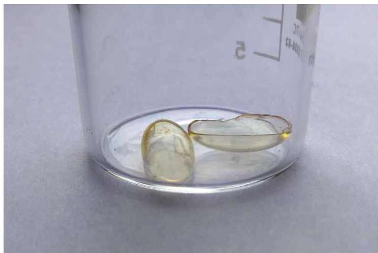
Рис.6. Фото оболонки зразка №1431/3, промитої гексаном
